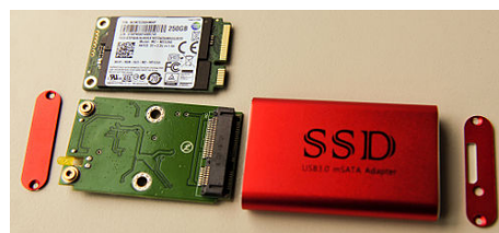
En isärskruvad SSD som bara består av IC-kretsar.
